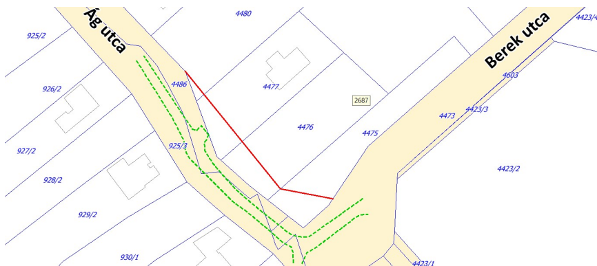
16. ábra - A szabályozási vonal és az útpálya helyzete (A FEFTERV Kft. kiviteli terve alapján készült (saját ábra)
